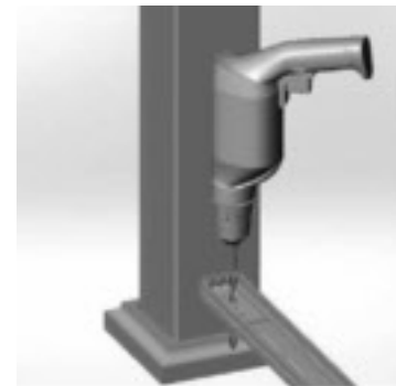
Dibujo 10: SOPORTE DE ACCESORIOS DE PERFORACIÓN AGUJEROS DE PERNO DE MONTAJE A TRAVÉS DEL ESTIFENADOR DE ALUMINIO
