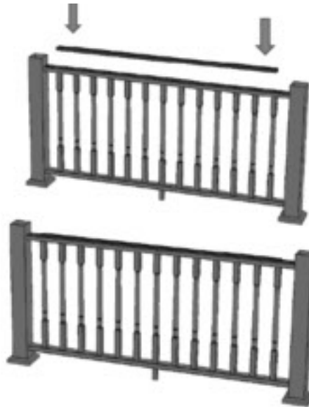
Dibujos 22A y 22B: INSTALE EL STIFENADOR SUPLEMENTARIO DE I-BEAM PARA RIELES DE 8' DE LARGO
