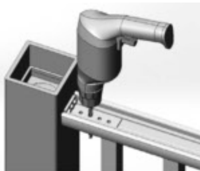
Dibujo 18 - TALADRE LOS AGUJEROS DE PERNO LATERAL EN EL CARRIL SUPERIOR
