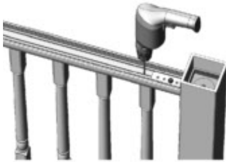
Dibujo 20B: UBICACIONES DE TORNILLOS DE BALUSTER GIRADOS
